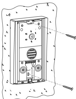
Presentar la placa a pared, colocando la parte superior de la placa a 1,65m. del suelo y pasar los cables de instalación a través de la entrada de cables.
