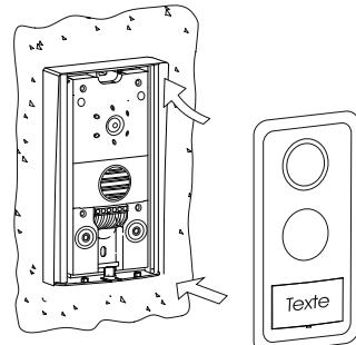
Avec l'aide d'un tournevis fixer au moyen des vis situés dans la partie inférieure de la plaque.
