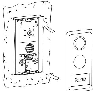
Con la ayuda de un destornillador, fíjelo mediante los tornillos situados en la parte inferior de la placa
