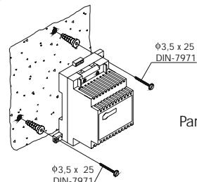
Instale el transformador en un lugar seco y protegido.
