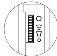
**I**nterruptores de configuración del monitor.
