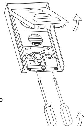
Con la ayuda de un destornillador plano, retire el frontal metálico haciendo una ligera presión en los orificios situados en la parte inferior de la placa, tal como se muestra en el dibujo.
