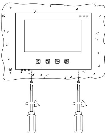
Avec l'aide d'un tournevis fixer au moyen des vis situés dans la partie inférieure du moniteur.
