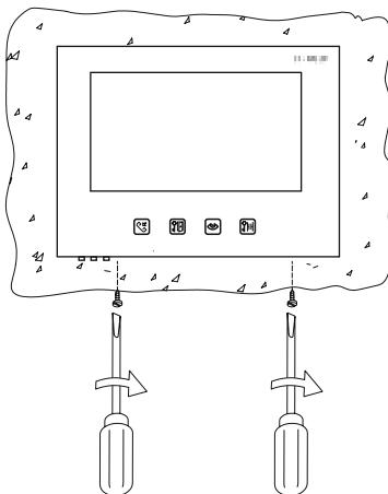
Con la ayuda de un destornillador, fíjelo mediante los tornillos situados en la parte inferior del monitor.
