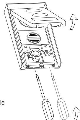
Avec l'aide d'un tournevis plat, retirer la partie frontale métallique effectuant une légère pression dans les orifices situés dans la partie inférieure de la plaque, comme indiqué sur le dessin.
