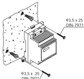
Installer le transformateur dans un endroit sec et protégé.
